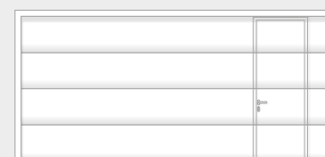
Disposición asimétrica para el ancho de la puerta con BRB 2000 - 3500 mm - desde el centro, izquierda o derecha
