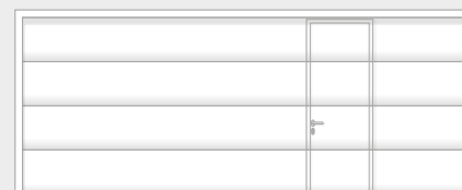
Disposición asimétrica para el ancho de la puerta BRB 3501 - 5000 mm - desde el medio, izquierda o derecha
