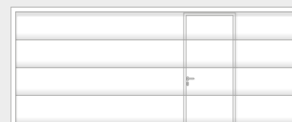
Disposición asimétrica para el ancho de la puerta BRB 4251 - 5000 mm - descentrado izquierda o derecha
